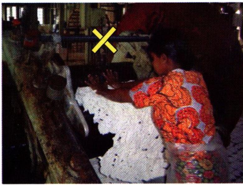
3. රබර් අඡරන යත්තු වල රෝල් වලට ඉදිරියෙන් දැඩු ආවරණයක් (Bar Guard), හොපරය (Hopper) සහ බෛස් ජ්ලේට් (Brace Plate) යන කොටස් නිසියාකාරව සවිකර ඇති බවට තහවුරු කර ගත්ත.
